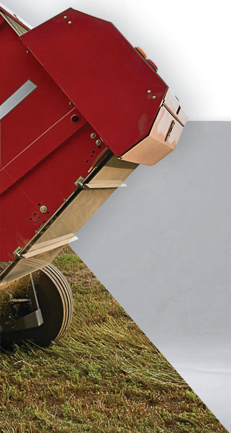
Nuestro exclusivo sistema de cilindros cuádruples (QCS) optimizan la densidad del rollo para sus condiciones y garantiza que las correas no se desplacen al pasar por el portón trasero. Un pateador hidráulico simplifica el expulsado de los rollos suavemente y los coloca fuera del recorrido del portón trasero. Con solo seis cadenas de transmisión en las arrolladoras modelo A y bloques de engrase en cada lateral, encontrará la simplicidad que facilita el mantenimiento y las reparaciones.
