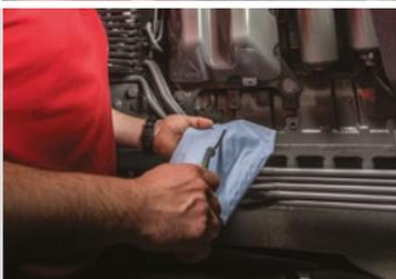
Fácil acceso para la limpieza del filtro de aire del motor. Hasta el 90% del polvo se elimina de manera natural por medio de la succión que producen los gases de escape.
