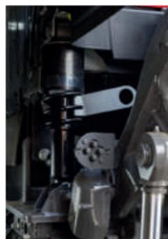
El **SISTEMA DE SUSPENSIÓN MECÁNICA ACTIVA DE LA CABINA** utiliza casquillos para los bloques silenciosos y amortiguadores con muelles para ofrecerle una amortiguación óptima en cualquier situación de conducción. Además, permite ajustar la firmeza de la marcha.
