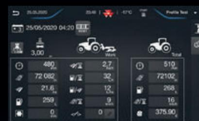
▶ **Memorización de los datos y los ajustes:** el número ilimitado de configuraciones de ajustes de usuarios permite registrar durante el funcionamiento información sobre la superficie trabajada, el consumo de combustible, el número de horas trabajadas, etc. El terminal Datatronic permite almacenar todos los ajustes y parámetros. Todos estos ajustes pueden almacenarse y recuperarse para localizar el ajuste previo usado en un tractor.
