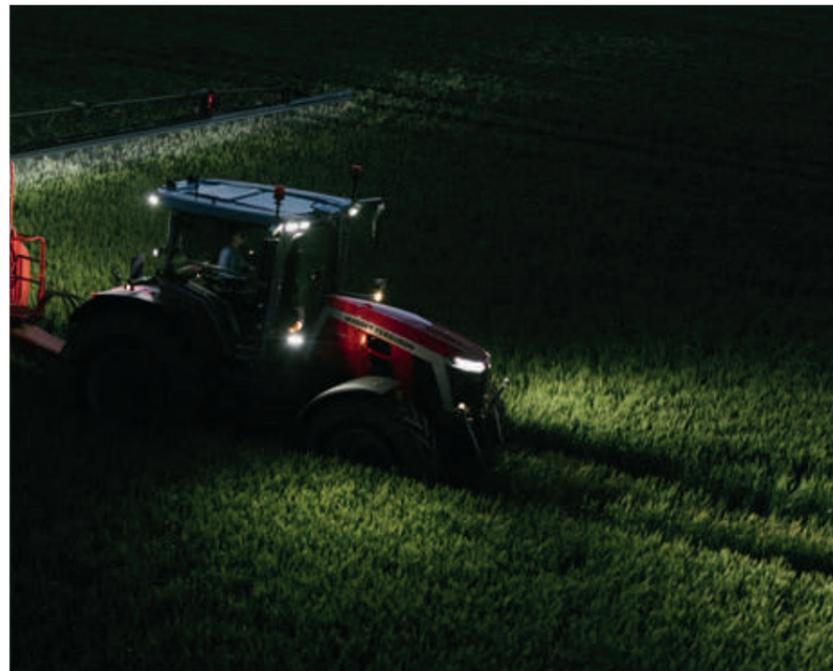
Las **16 LUCES LED OPCIONALES** transforman la noche en día. Las especificaciones de serie del MF 8S incluyen la activación automática de la luz de baliza y el apagado automático de las luces de trabajo para bajar del tractor con seguridad en condiciones de oscuridad.
