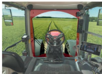
**LOS ESPEJOS RETROVISORES LATERALES** presentan una sección superior e inferior ajustable que ofrece la mejor visión durante el transporte y reduce los puntos ciegos. Hay espejos retrovisores calefactados y con ajuste electrónico disponibles como opción.
