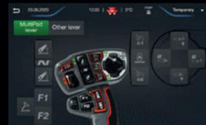
▶ **Asignación de los comandos del apero ISOBUS a la palanca Multipad:** los aperos ISOBUS pueden controlarse directamente mediante la palanca Multipad. Tener todos los controles (tractor y apero) en la misma palanca es mucho más cómodo que tenerlos repartidos entre varias pantallas y palancas.
