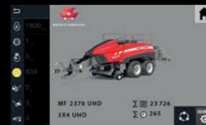
▶ **Control total de los aperos mediante ISOBUS:** ISOBUS permite visualizar en la pantalla del terminal el sistema de control del apero, lo que ahorra tiempo, dinero y la necesidad de instalar monitores adicionales en la cabina. Basta con conectar el cable del apero en la toma ISOBUS del tractor para que el sistema cargue automáticamente los menús de funcionamiento y los muestre en la pantalla.
